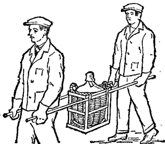
Рис. 13.12. Переноска бутыли с кислотой
